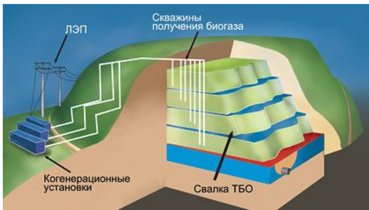
Объект: Свалка твердых бытовых отходов
